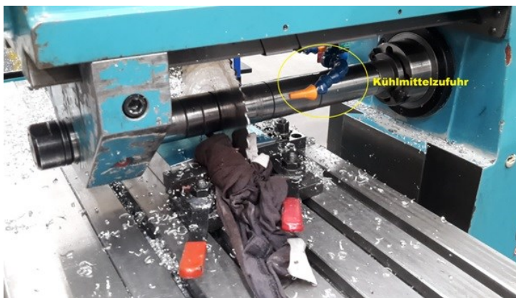
Abbildung 31: Kühlmittelzufuhr und eingezogener Putzlappen am Sägeblatt
